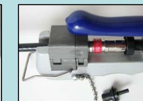
Zamknąć górną zastawkę. Zamknąć uchwyt w celu zaciśnięcia.
