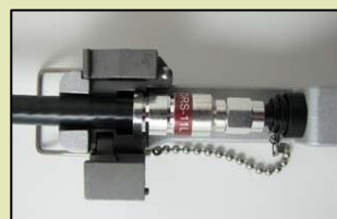
Otworzyć górną zastawkę 7/11 i włożyć złącze
