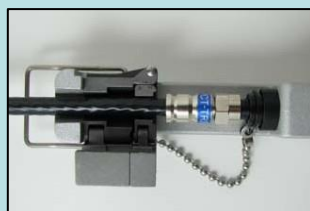
Podnieść górną zastawkę i włożyć złącze
